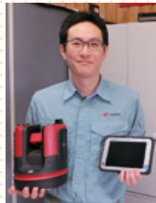
建物を正確に計測する三次元測定器と、それをコントロールするタブレットPC
